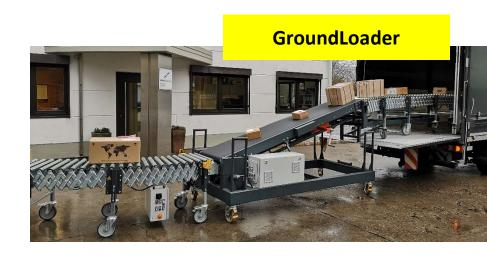
angetriebene Scherenrollenbahn auf einem Ausleger montiert sind. Der Gurtförderer ist hydraulisch auf die Höhe des Lkws bzw. Wechselbehälters einstellbar. Die Scherenrollenbahn wird gemäß dem aktuellen Grad der Beladung an die entsprechende Belade- bzw. Entladeposition gezogen. Eine bewährte Lösung ist, wenn der GroundLoader um eine weitere Scherenrollenbahn ergänzt wird, die das Transportgut z.B. in eine Lagerhalle abfördert.
