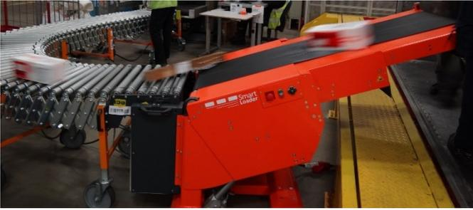
Als universal einsetzbar hat sich eine Kombination mit angetriebenen Scherenrollenbahnen als Alternative zu Teleskopförderern entwickelt.
