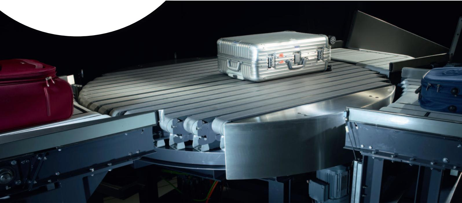
Typische Sortier- und Verteiltechniken erfüllen oft nicht die Anforderungen kleinerer und mittlerer Fördersysteme, bei denen die Platzverhältnisse beengt sind und die Sortierleistungen unterhalb von 3.000 Stück/h liegen. Auch werden variierende Materialstromrichtungen nicht berücksichtigt, wie es z.B. bei den Import- und Export-Prozessen von Paket- und Express-Dienstleistern notwendig ist.
